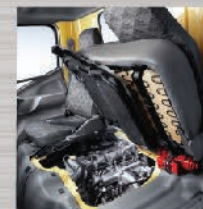
Inspection Lid Berada di bawah jok penumpang, pengecekan mesin lebih mudah.
