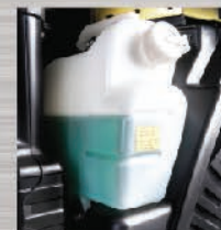
Tangki Radiator Posisi di bagian luar sehingga mudah dikontrol.
