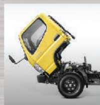
Kabin Jungkit Mudah dalam pemeriksaan dan perawatan mesin.
